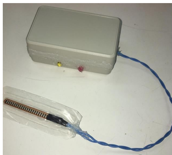
b. Caixa fechada e já com o silicone passado em todas as partes necessárias.
