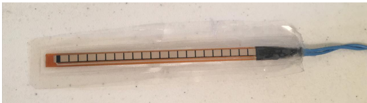
Figura 22: Encapsulamento do Sensor de Flexão
